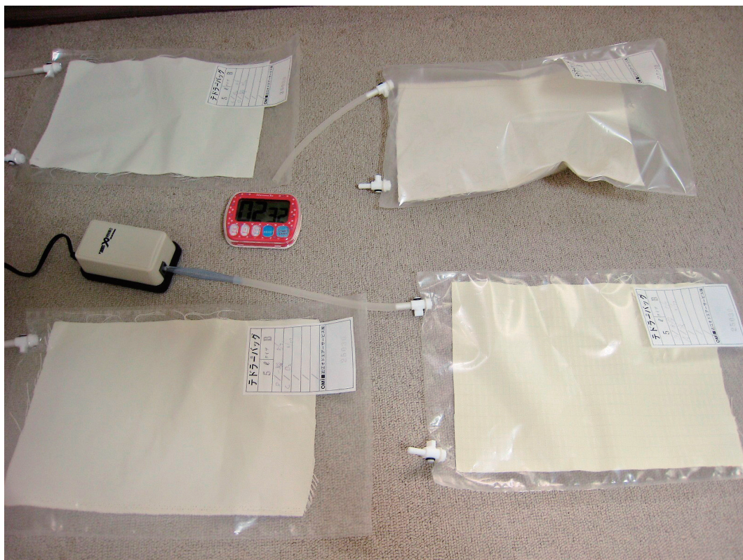
写真 2. 第 3 回予備実験で使用したエアバック内に入れた各種消臭カーテン素材
